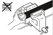
• Надеть внешнюю гайку концевого крепежа на рукав до упора без какой-либо смазки.
