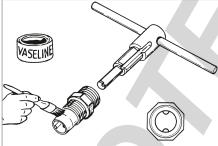
• На резьбу втулки нанести тонкий слой вазелиновой смазки или смочить втулку водой; Запрещается снимать фаски и нарушать целостность слоев рукава!
